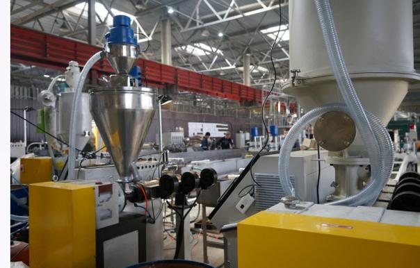
Производство термоэластопластов, используемых для уплотнителей, деталей интерьера автомобилей и кабельной изоляции.
